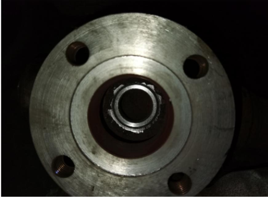
球阀修复的注意事项：(1)必须先查明球阀上、下游管道确已卸除压力后，才能进行拆卸分解操作。(2)非金属零件清洗后应立即从清洗剂中取出，不得长时间浸泡。(3)装配时法兰上的螺栓必须对称、逐步、均匀地拧紧。(4)清洗剂应与球阀中的橡胶件、塑料件、金属件及工作介质(例如燃气)等均相容。工作介质为燃气时，可用汽油清洗金属零件。非金属零件用纯净水或酒精清洗。(5)分解下来的每个球阀零件可以用浸洗方式清洗。尚留有未分解下来的非金属件的金属件可采用干净的细洁的浸渍有清洗剂的绸布擦洗。清洗时须去除一切粘附在壁面上的油脂、污垢、积胶、灰尘等。
