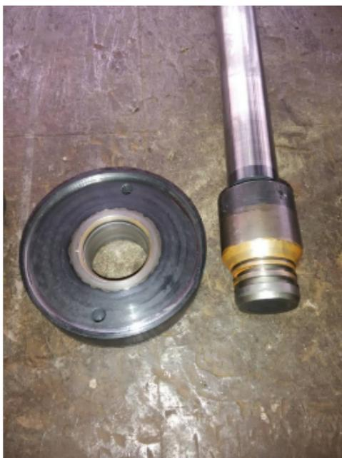
阀门用久后，怎么修复密封面、提升气密性？清洗和检查过程：清洗密封面在油盘内，使用专业清洗剂，边洗边检查密封面的损坏情况。用肉眼难以确定的细微裂纹可用着色探伤法进行。经过清洗后，应检查阀瓣或闸阀与阀座密封面的密合情况，检查时用红色和铅笔。用红丹试红，检查密封面印影，确定密封面密合情况；或用铅笔在阀瓣和阀座密封面上划几道同心圆，然后将阀瓣与阀座密合旋转，检查铅笔圆圈擦掉情况，确定密封面的密合。如果密合不好，可用标准平板分别检验阀瓣或闸板密封面和阀体密封面，确定研磨部位。阀门配件加工的方法有：修配法。苏州止回阀门配件加工
